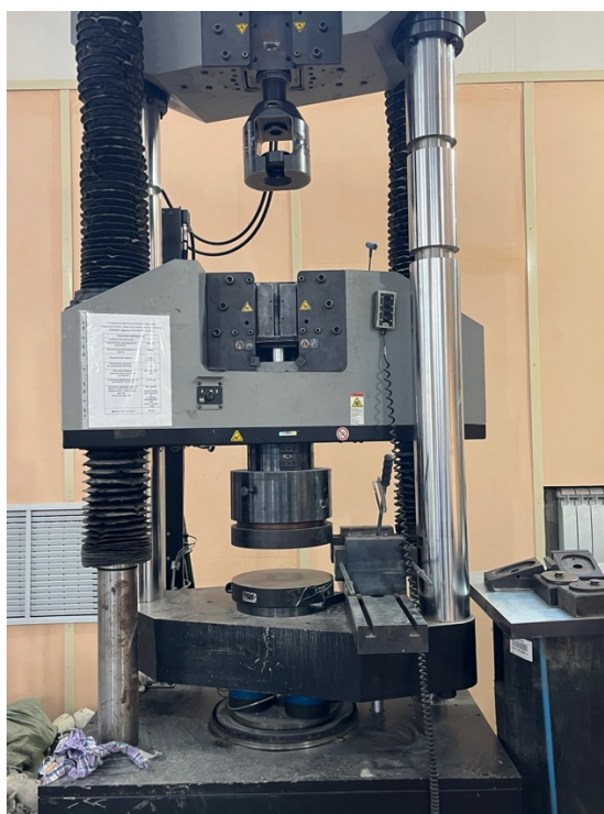
Рис. 1. Лабораторные испытания арматуры на изгиб согласно ГОСТ 12004-81
