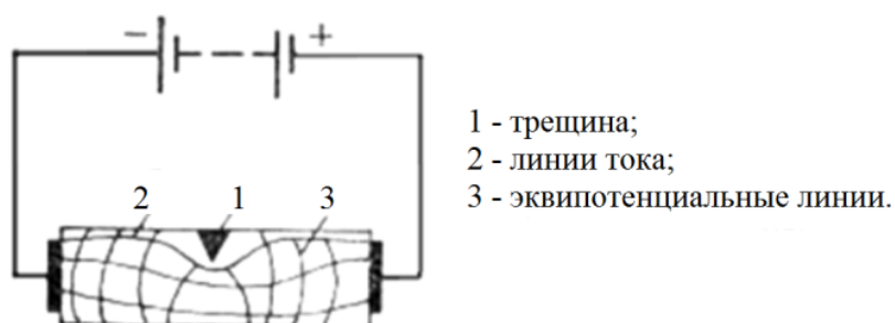
Рис. 2. Электрический метод неразрушающего контроля
